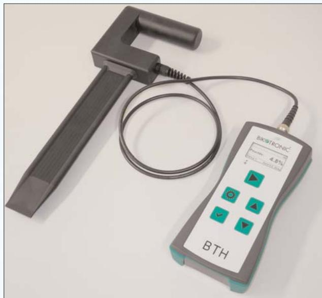
Das neue BTH ist ein portables Feuchtemessgerät zur Bestimmung des Feuchtegehalts in Schüttgütern wie Sand, Kies und Splitt. Das BTH zeichnet sich durch eine präzise Messung und benutzerfreundliche Handhabung aus.
